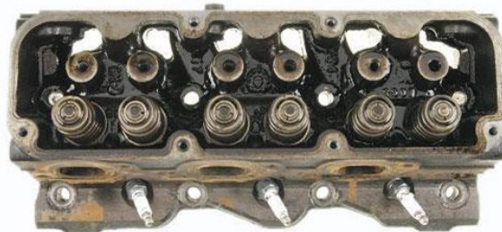
รูปที่ 3 หัวสูบก่อนการทำความสะอาด ซึ่งมีคราบและยางเหนียว
