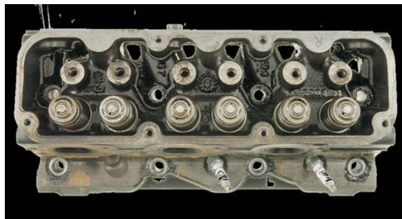
รูปที่ 4 หัวสูบหลังจากการทำฟลัชซึ่งด้วยน้ำยาของ AMSOIL ซึ่งมีคราบและยางเหนียวน้อยลงมาก
