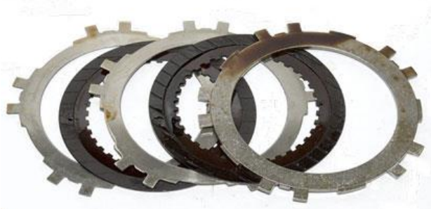
รูปที่ 2 แผ่นคลัทช์ หลังจากการทำฟลัชซึ่งด้วยน้ำยาของ AMSOIL ซึ่งมีคราบและยางเหนียวน้อยลงมาก
