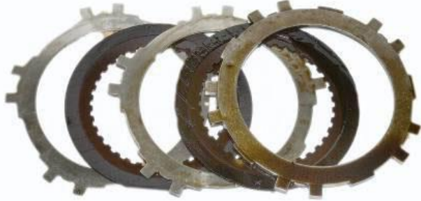
รูปที่ 1 แผ่นคลัทช์ ก่อนการทำความสะอาด ซึ่งมีคราบและยางเหนียว
